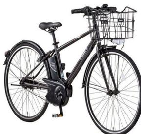
Sua roda é do tipo 700 x 32c, mede 1,84 metros de comprimento, 58 cm de largura (contando a cesta) e pesa 23,5 kg.
